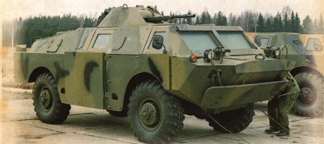
Модернизированный вариант БРДМ-2 с демонтированными дополнительными колесами, дверью в борту и экранировкой корпуса.
