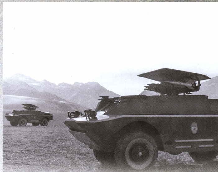
Боевая машина 9П133 — пусковая установка ПТРК «Малютка» на базе БРДМ-2.
