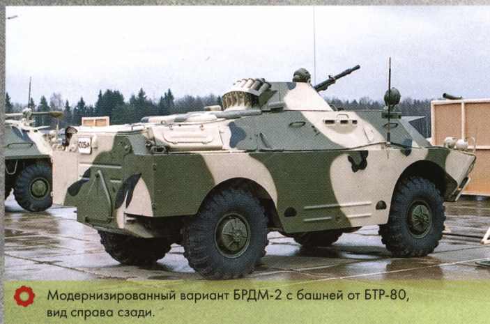
Модернизированный вариант БРДМ-2 с башней от БТР-80, вид слева сверху.
