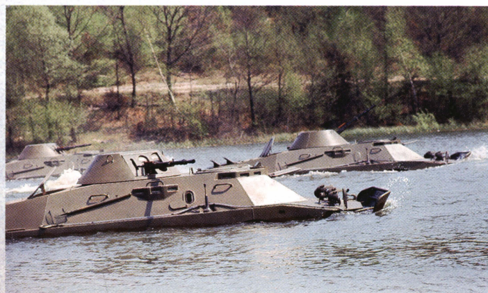
Подразделение БРДМ-2 форсирует водную преграду в ходе учений. Хорошо видно, что на плаву машины имеют дифферент на корму.
