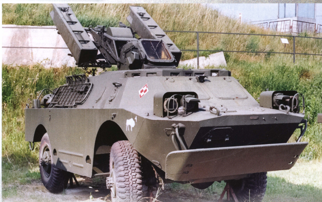
Боевая машина 9А31 (пусковая установка ЗРК «Стрела-1» на базе БРДМ-2) Войска Польского.
